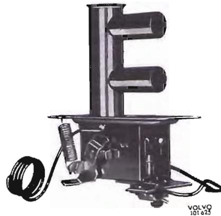
Abb. 19 Wärmekontrollventil
