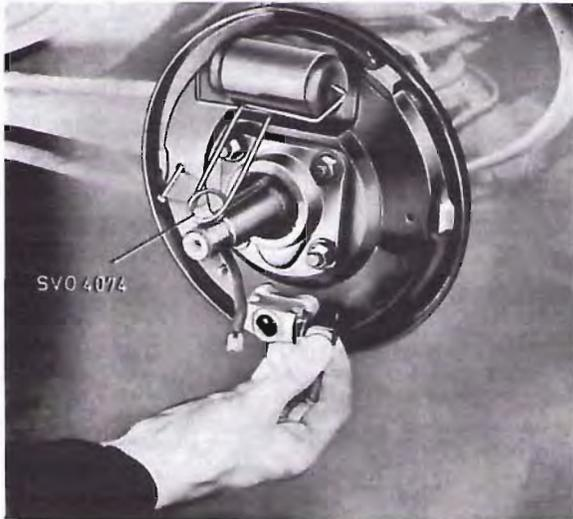
Abb. 28 Ausbau der Einstellkolben
