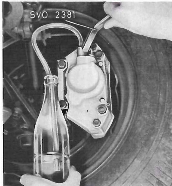
Abb. 71 Entlüftung mit Aggregat VOLVO 26933
