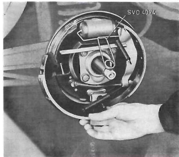
Abb. 27 Ausbau der Bremsbacken
