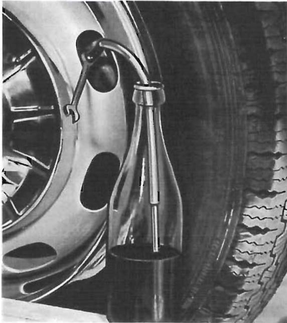
Abb. 72 Mechanische Entlüftung VOLVO
