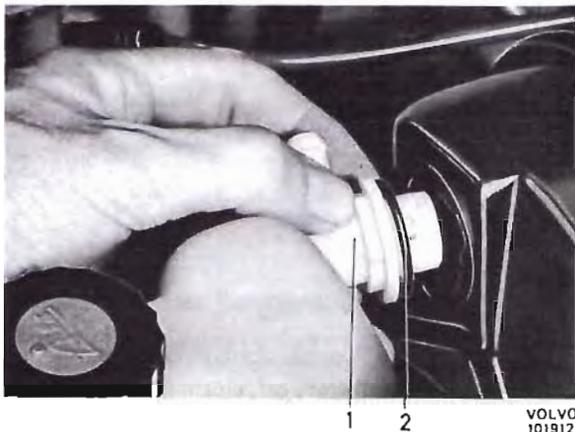
Abb. 107 Einbau des Rückschlagventils, Typ 2
