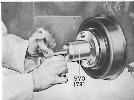
Abb. 26 Ausbau der Hinterradnabe
