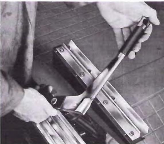
Abb. 113 Ausbau des Handbremshebels, 120
