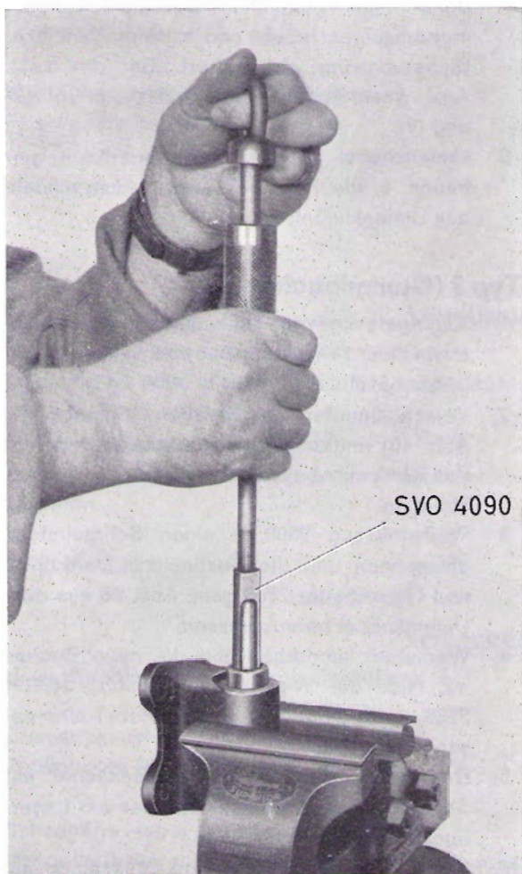
Abb. 62 Ausbau der Nadellager
