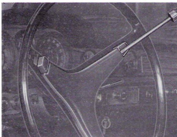
Abb. 41 Ausbau des Stoßpolsterung, Lenkradnabe
