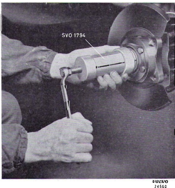
Abb. 22 Ausbau des inneren Radlagers
