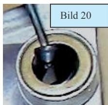
aller erst die Drosselklappe ausgebaut werden. Dreht man die beiden Schrauben ab, lässt sich nach einem 90° Schwenk der Drosselklappenwelle die Drosselklappe nach vorne aus dem Schlitz der Welle ziehen. Feder aushängen und Welle herausziehen folgt als nächstes. Nun können mit einem Schraubenzieher die beiden Buchsen (Bild 20), rechts und links herausgehoben werden. Bohrung reinigen und anschließend die neuen
