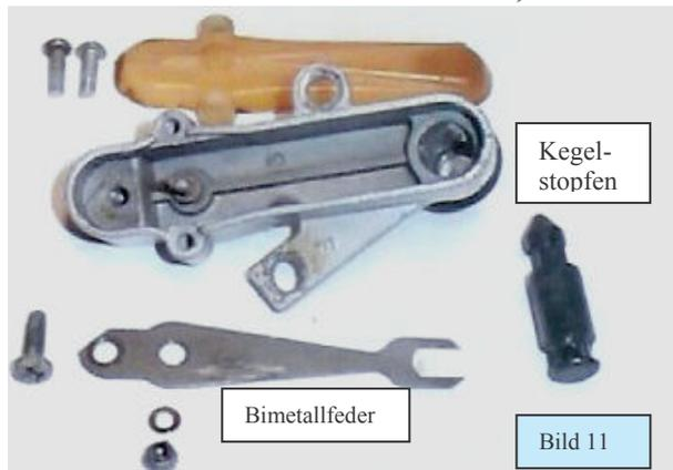
Bimettalfeder und dem Kegelstopfen bestehen, erkennen. Nach Lösen der Schraube und der Mutter können Bimettalfeder und Kegelstopfen (Bild 11) entnommen werden. Die Teile werden gereinigt und wieder montiert. Die Funktion kann man mit Wasser sehr gut überprüfen. Dazu wird eine Schüssel mit Wasser gefüllt, und der vormontierte Kompensator hineingelegt. Bei kaltem Wasser bleibt das Ventil geschlossen. Füllt man jetzt stetig heißes Wasser dazu muss der Kegel sich bei
