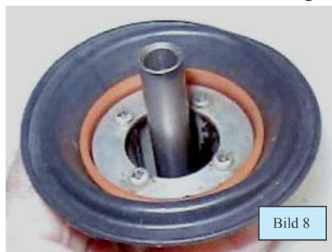
dem Spezialwerkzeug drehen sie im Uhrzeigersinn, um das Gewinde des Nadelgehäuses mit dem Nadeleinsteller in Eingriff zu bekommen. Anschließend drehen sie so lange weiter bis die Kerbe im Nadelgehäuse mit der Madenschraube ausgefluchtet ist., und ziehen die Madenschraube an. Als nächstes wird die Membran wieder in den Luftkolben montiert, wobei darauf zu achten ist, dass die Zunge der Membran in die Aussparung des Luftkolbens positioniert wird. Legen sie den Haltering und falls
